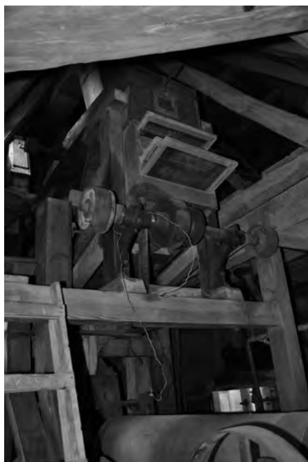
Aspiratér, zařízení na vstupní třídění a čištění obilného zrna před mletím, 2022 (foto Petra Hrbáčová)
