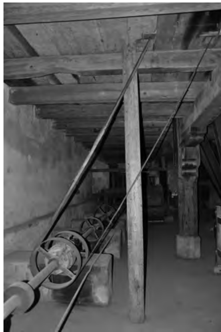
Transmise v suterénu mlýna, na pozadí tzv. mlýnský pranýř, 2022 (foto Petra Hrbáčová)
