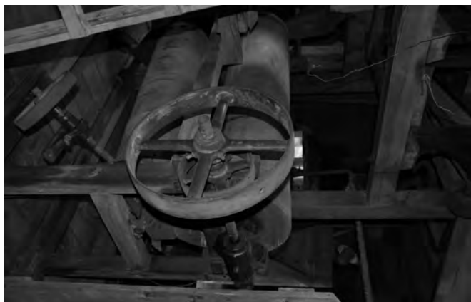
Válcový koulník (trier) na čištění obilného zrna od kulovatin, především semen jedovatého koulí, 2022 (foto Petra Hrbáčová)
