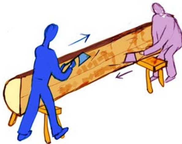
I Tesání střídavé na jednu stranu zprava a na druhou zleva
