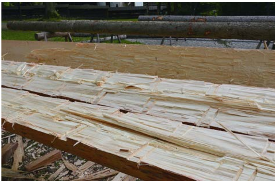
Plocha podélně rozštípnuté kulatiny se stopami po otvorech vrтанých nebozezem a dlabech pro umístění štípacích klínů • 2017
