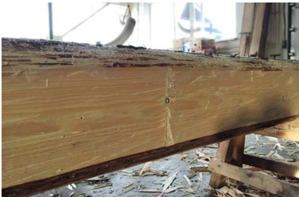
Stopy po vrubování na nově vyráběném prvku
