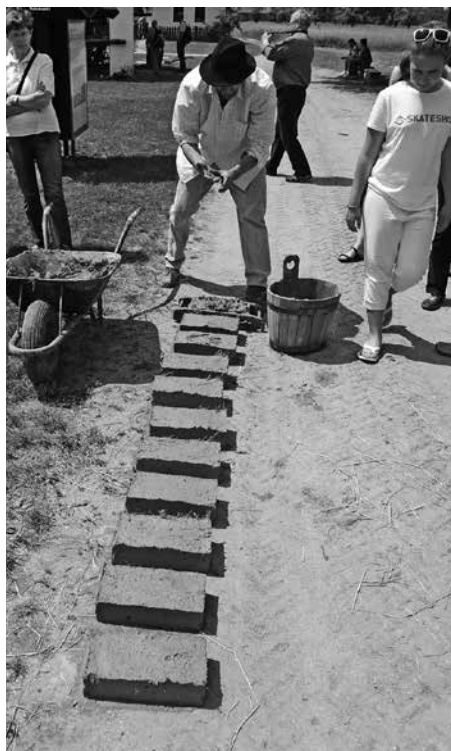
Martin Novotný prezentuje výrobu nepálených cihel v Muzeu vesnice jihovýchodní Moravy při MFF Strážnice, 2013, foto R. Bryol
