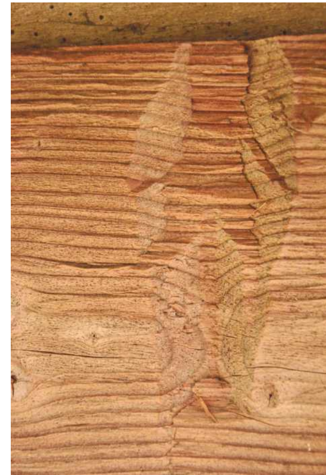
13 ] Dno vrubovaného žlábků od párového vrubování z postoje vedle kulatiny uložené na kozách
