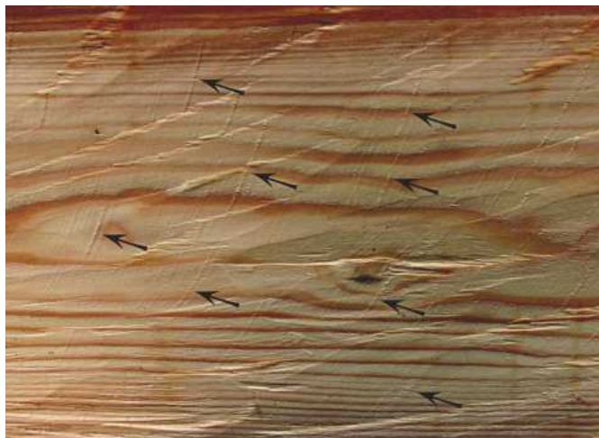
10 ] Rýhy na opracované ploše kopírující trajektorii dopadu břitu sekery
