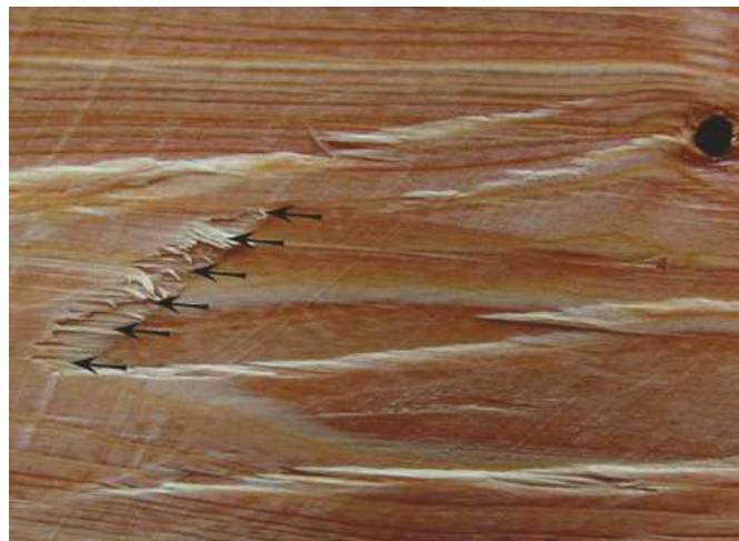
11 ] Zatrhnutí způsobené patou širočiny
