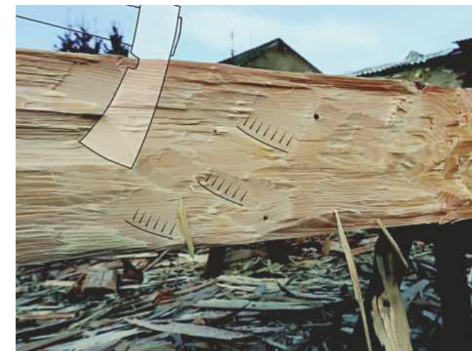
38] Povrch líce po hrubování pomocí pantoku
