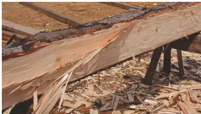
43] Visící soudržné odštěpky při lícování pravotočivé kulatiny
