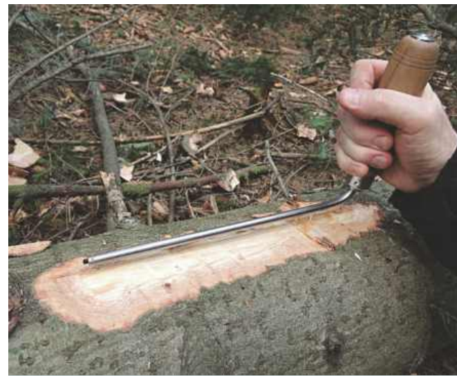
4] Jednoduchá lesnická pomůcka zvaná črták pro stanovení točitosti kmene
