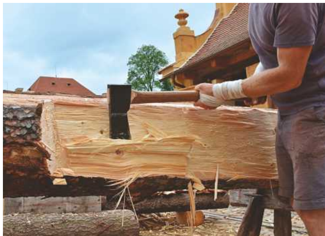
28 | Hrubování při běžném postoji, kdy kulatina na kozách je ve výšce pasu
