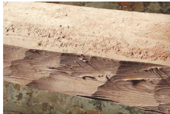
46] Stopy po opracování sekerou s prohnutou čepelí
