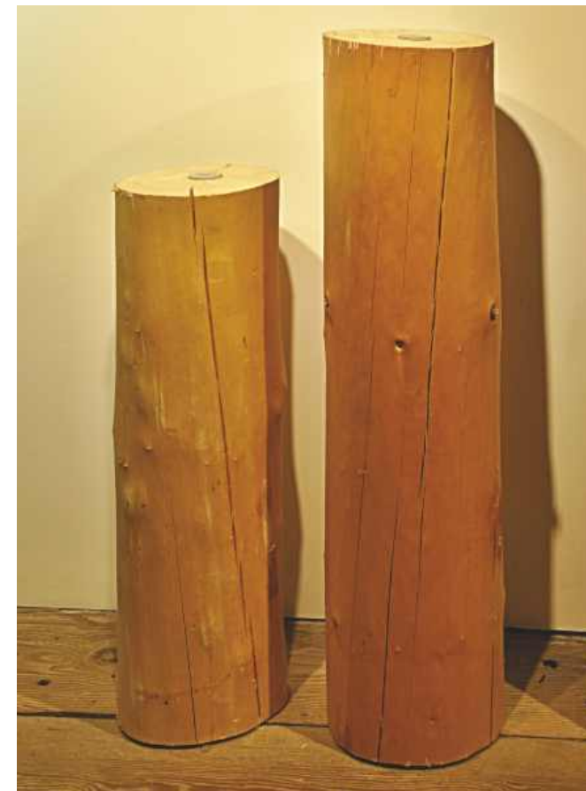
2] Ukázka levotočivého a pravotočivého kmene
