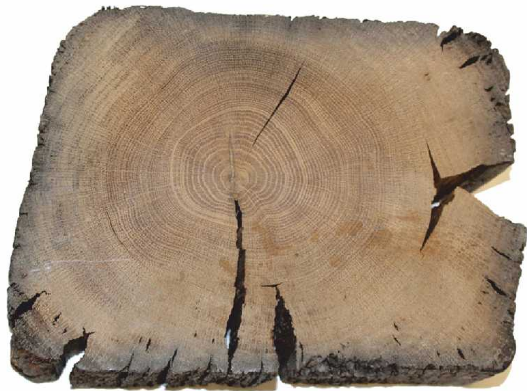
2] Příčný řez z dubového trámu
