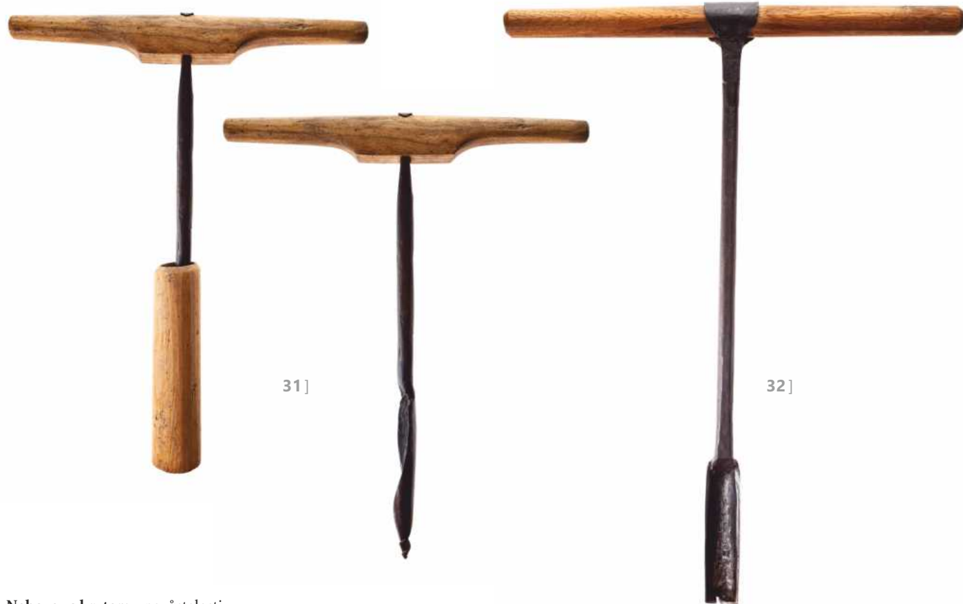
31] Nebozez s krytem z pozůstalosti tesaře Josefa Žaluda (* 1895) z Kaliště u Lipí
