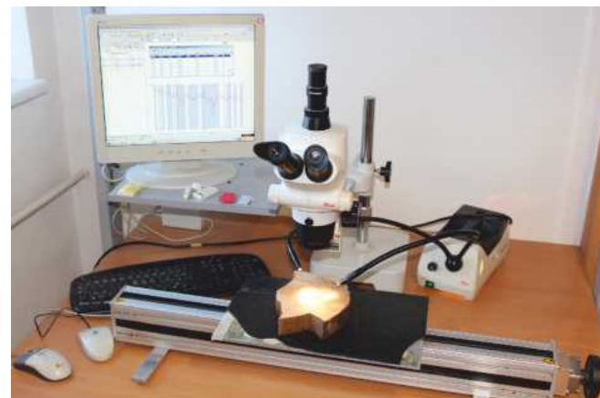
3] Měřicí stůl VIAS TimeTable s programem PAST4 (©SciEm)
