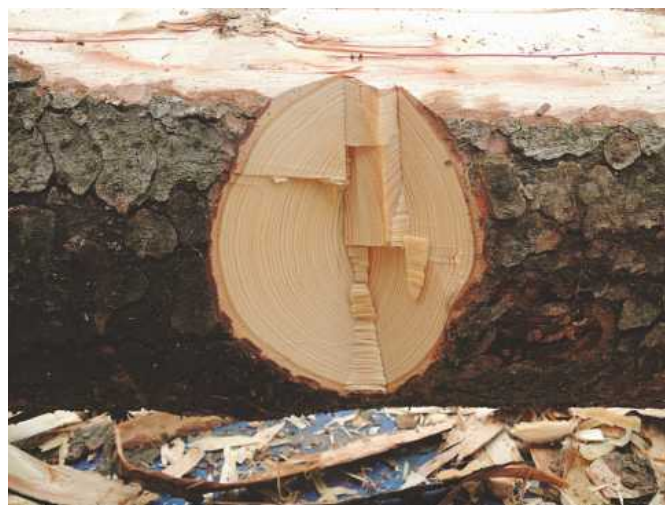
21 | Detail vrubu po vrubování při postoji na kulatině
