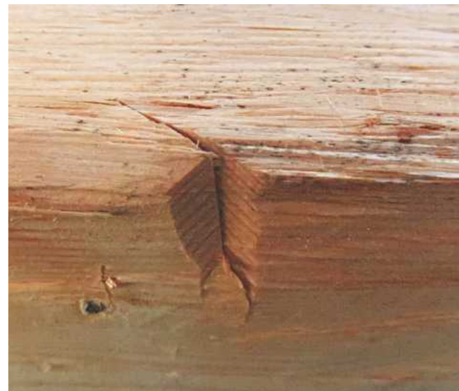
12 ] Přetrnutí vláken s překříženými záseky od vrubování z postoje na kmeni
