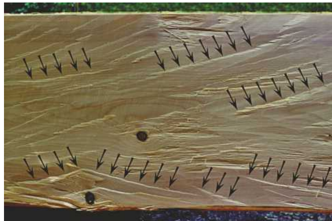
44] Při nepříznivé točitosti má tesař nakloněnou sekeru na špici, prosekává spodní hranu, místo suku taktéž obseková
