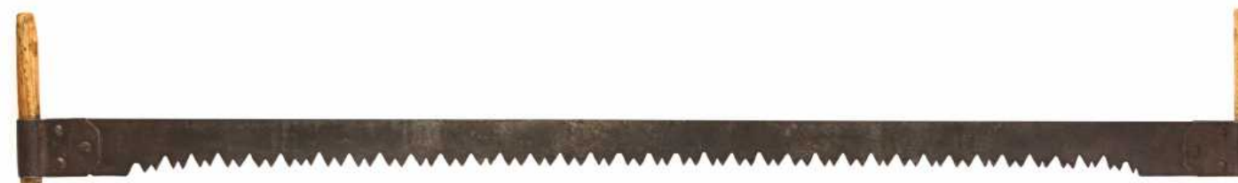
35] Příčná pila – tloušťka listu 2 mm z pozůstalosti tesaře Václava Horáčka (* 1891) z Jakuba u Kutné Hory
