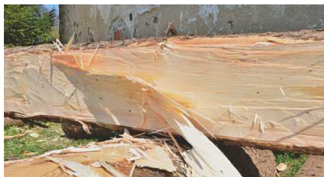
45] Visící soudržné odštěpky při lícování levotočivé kulatiny
