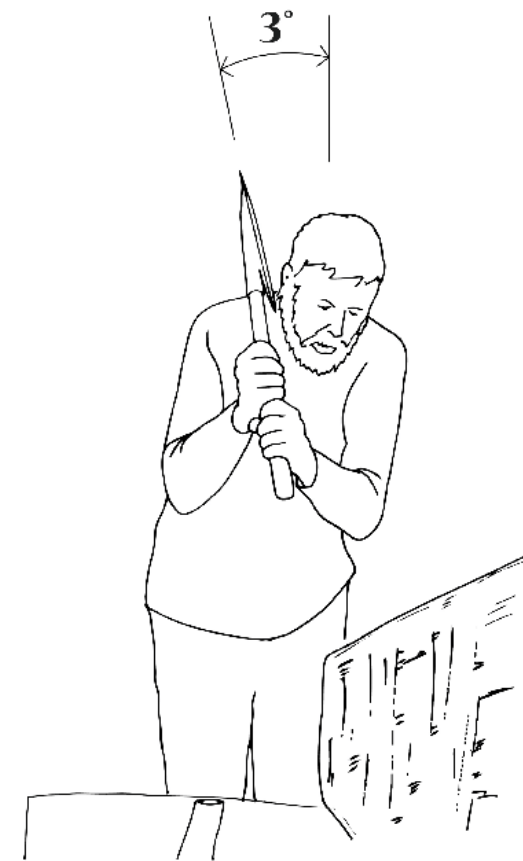
42] Úder širočinou je veden po svislici v rozsahu odklonu do cca 3° ven
