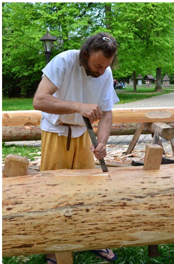
Obr. 25 Přetínání točitých vláken ve štěpné spáře
