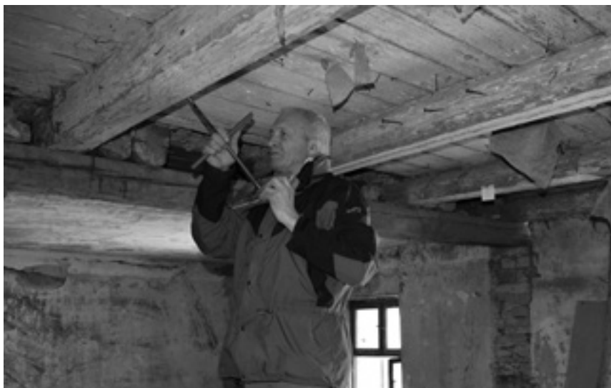
Josef Kyncl odebírá vzorek ze stropního trámu, 2016 (foto J. Koudelová)
