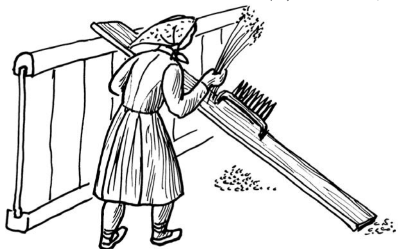
Obrázek 63: Drhlen zhotovený kovářem. Na kramli délky asi 30 cm jsou nakovány 18 cm dlouhé zuby s průřezem čtvercovým nebo kruhovým. Hranaté provedení je méně výhodné, neboť na hranách zubů se vlákna lnu zadržovala. Při práci se nástroj vbil do fošny nebo trámu jedním koncem pozvednutého na oplotu přístodůlku, druhým spočíval na zemi. Pracovalo se u něho vstoje. Pro dvě a víc pracovnic se trám položil mezi dvě lavice. Dělnice pak u drhlenů seděly střídavě na obou stranách trámu.
