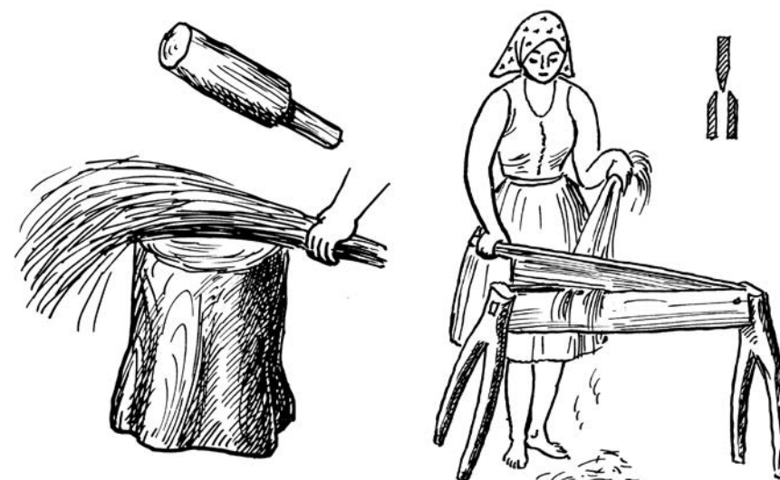
Obrázek 73: Tlučení vlákna stébla pomocí tlouku Obrázek 74: Lámka jednobřítá
