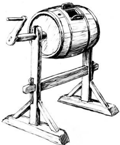
Obrázek 226: Máselnice ze sudu s rotační vnitřní konstrukcí. V jiných typech v pevně uchycené nádobě rotovaly lišty s otvory.
