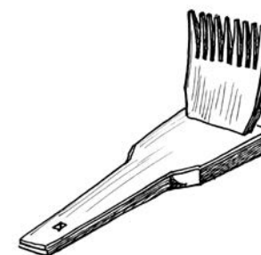
Obrázek 62: Dřevěný drhlen vsazený do lopatovité podložky délky 80 cm. Ta se zaklesla do lavicové sedačky nebo mezi trámy stěny či oploty a zajistila se závlačkou. Pracovnice seděla na nízké stoličce. Podle dochovaných kusů se celková délka drhlenů pohybovala okolo 80 cm, délka zubů činila 20 cm.
