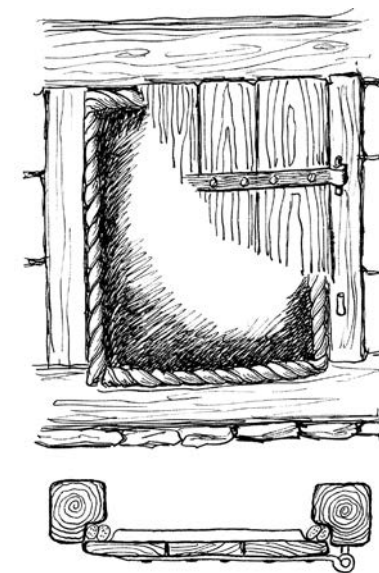
Obrázek 138: Zimní utěsnění dveří chléva slaměnými pletenci.
