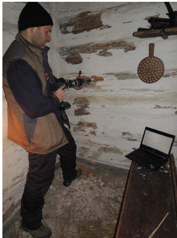
Obr. 20 Celkový pohled na měření pomocí přístroje umožňující měření mechanických vlastností ve vrtu
