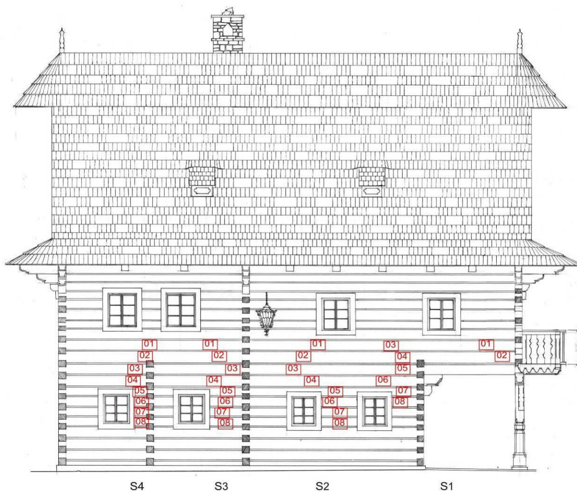
Obr. 21 Sektory S1, S2, S3 a S4 na levé podélné stěně Rožnovské radnic.
