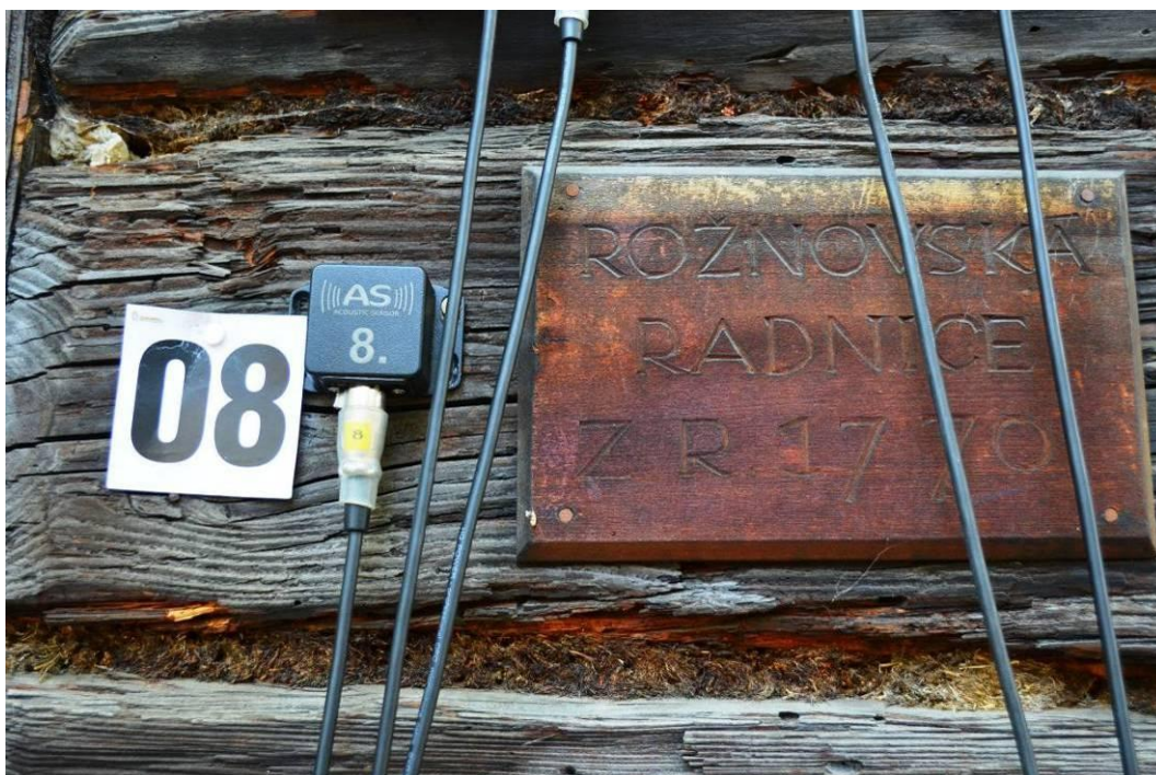
Obr. 3 Zařízení Acoustic pack při detekci aktivity larev dřevokazného hmyzu
